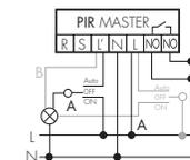
Bei Schaltung von netzparallelen Induktivitäten (Leuchtstofflampen, Schütze etc.) kann ein RC-Glied nötig sein.
